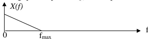
Par échantillonnage idéal on lui fait correspondre le signal échantillonné  $x_e(t)$  défini par ses échantillons  $x(nT_e)$  où  $T_e$  est la période d'échantillonnage.
