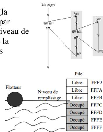
petites adresses car l'empilement des données dans la pile (remplissage: push) se fait par décrémentation du SP et le depilement (vidage:pop) se fait par incrémentation du SP.
