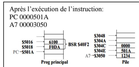
Pour Le MC68000 il n ya pas d'instruction explicite push et pop la manipulation de la pile se fait avec l'instruction move. Les opérations effectuées par BSR ou JSR et RTS ou RTR, se résument dans ce qui suit
