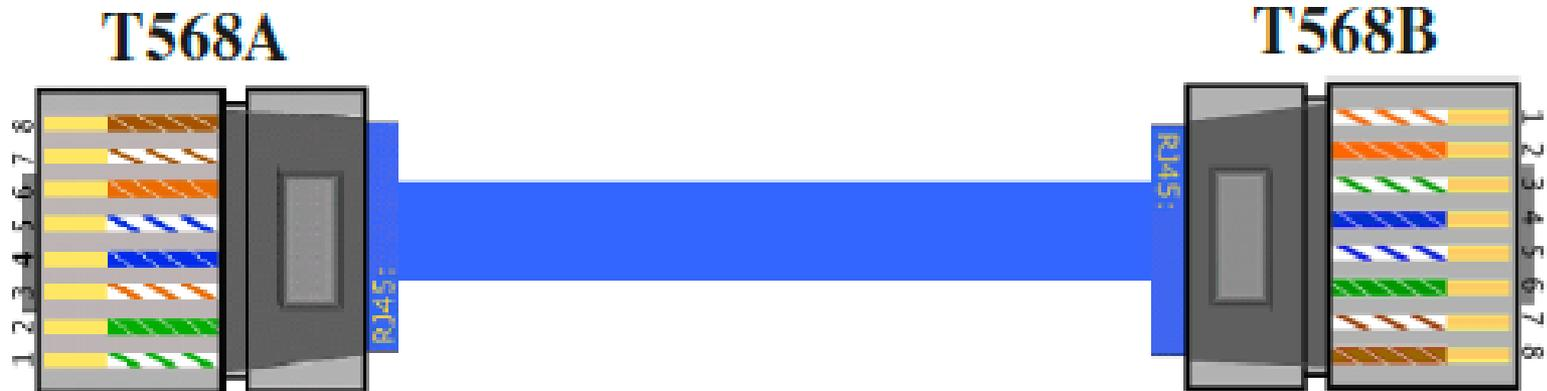
Ce type de câble vous permettra de relier directement deux ordinateurs entre eux sans passer par un hub ou un switch. En fait, le câble est composé de 4 paires de fils de cuivre torsadés, et le câble doit respecter une norme de câblage bien précise.
