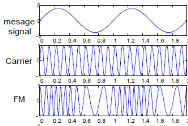
La forme générale d'un signal FM s'écrit :  $FM = A_p \cos[\theta(t)]$  où la phase  $\theta(t)$  du signal à l'instant  $t$  (appelé phase instantanée) est égale à: phase instantanée de la porteuse non modulée  $\omega_p t$  + un terme provenant de la modulation  $\varphi(t)$  qui représente l'écart de phase par rapport à la porteuse, contient l'information à transmettre.
