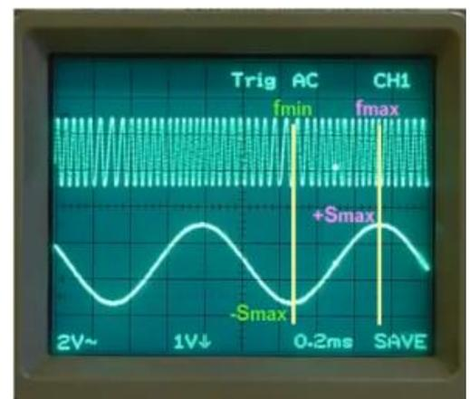
Donc, la fréquence du signal émis varie entre  $f_{\max} = 95.775$  MHz et  $f_{\min} = 95.625$  MHz
